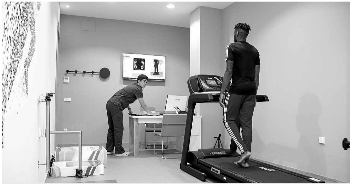
Sala de biomecánica con cinta sensorizada monitorizada con cámaras y un escáner 2d y 3d.
